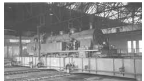
Schiebebhühne des Betriebswerks Saarbrücken Hauptbahnhof
